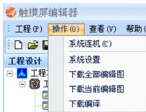
**系统连机：**利用RS-232串口通讯，将电脑和触摸屏连接，可选115200或9600波特率。
